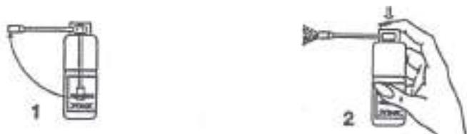
Al primo utilizzo del prodotto, per ottenere una regolare erogazione, prema alcune volte a vuoto il tasto erogatore.
